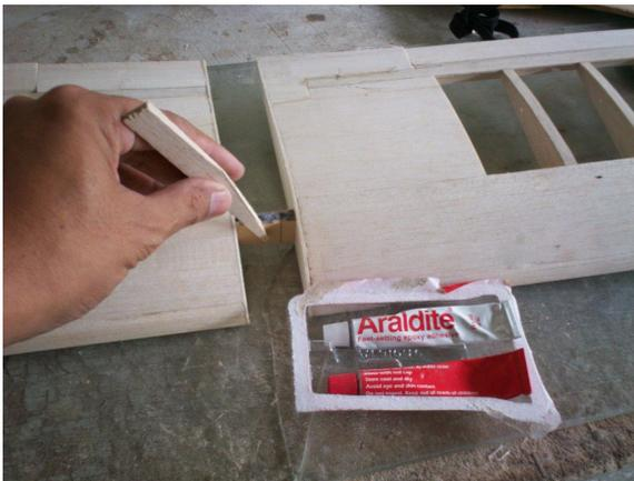
Sayap Pesawat model Cessna Electric Trainer terdiri atas 2 bagian yaitu sayap kanan dan sayap kiri. Keduanya perlu disambung di bagian tengah dengan central joiner yang telah disediakan. Oleskan lem epoksi yang sudah dicampur 1:1 ke Central Joiner, Lubang Spar dan rib-rib sayap tengah yang saling berhadapan sehingga hasilnya diperoleh sayap yang kokoh, rapi khususnya pada bagian persambungan dan tidak twist.
