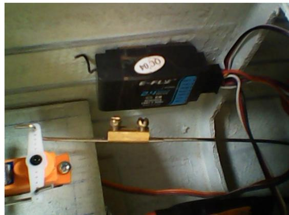
pada lengan servo elevator, aileron atau rudder. Ikuti instruksi yang diberikan untuk mengatur lengan kemudi khususnya mengukur gerakan keatas dan kebawah menggunakan template yang diberikan. Untuk penerbangan perdana sangat direkomendasikan anda mengemudikan dengan template sudut yang lebih kecil atau lebih lunak. Kemudian jika anda sudah cukup mengenal pesawat maka anda dapat meningkatkannya seperti yang anda sukai.
