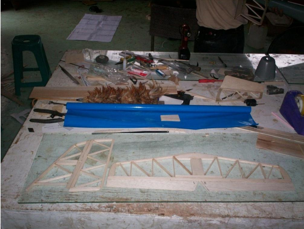
1. Lekatkan suatu landasan yang rata sebagai alas untuk bekerja. Pasang gambar rencana sehingga bagian ekor berada pada posisi yang tepat untuk dirakit. Rekatkan dengan isolasi lapkan sebuah atau selembar plastik diatas gambar tersebut untuk mencegah terkena lem pada saat perakitan.
