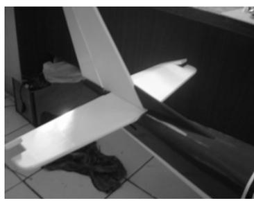
Lapiskan Epoksi yang sudah dicampur secara merata ke permukaan bawah ekor horizontal dan ke dudukan ekor di badan bagian belakang. Ekor Vertikal (Fin) harus dilem dengan epoksi pada ekor horizontal dan posisinya tegak lurus.
