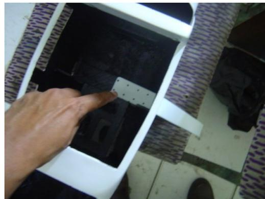
Roda depan atau Nose Gear dipasangkan pada Firewall di badan bagian depan tepat di bawah dudukan engine dan tangkai kemudinya dihubungkan ke servo penggerak kemudi belok atau rudder.
