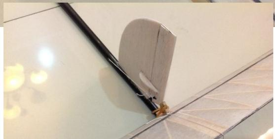
terdapat tangkai penahan ikatan. Ke bagian depan tangkai penahan diikat dengan karet gelang ke sisi kiri dan kanan melalui bawah tail boom. Karet gelang ini akan menarik stabilo sehingga terangkat 45 derajat untuk proses pengeremem keluar thermal (dethermalizer disingkat D/T).
