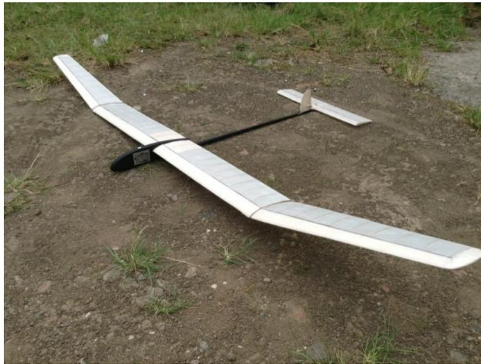
Untuk mendukung fungsi sebagai pesawat layang yang efisien, maka keseluruhan permukaan pesawat ini nantinya harus di finishing dengan proses modern dengan dope sanding sealer, sehingga memberikan permukaan yang tahan air.
