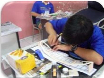
Sambungkan masing-masing panel sayap dengan disangga jig sayap di atas gambar rencana. Ketinggian Jig Sayap akan membentuk sudut hedral sayap. Pergunakan lem CA untuk penyambungan hedral sayap ini. Pemasangan sayap dengan sudut hedral nantinya diperlukan untuk kestabilan terbang dalam arah guling (lateral).
